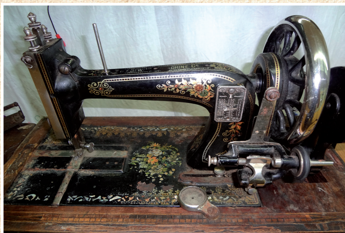
Машинка швейная ручная с горизонтальным челноком
